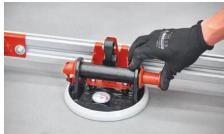
È consigliato l'utilizzo di apposite ventose vacuume idonee per la presa della lastra. Sollevare la lastra per il trasporto, controllando la tenuta delle ventose tramite il vuotometro.
