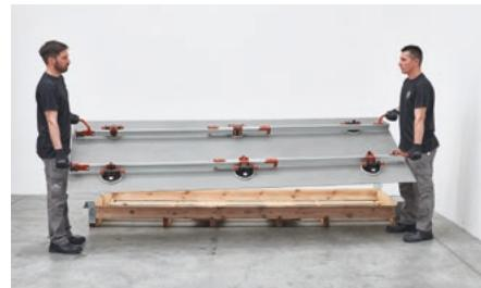
Pulire la superficie della lastra, all'interno della cassa o sul cavalletto prima di utilizzare il telaio per la movimentazione.
