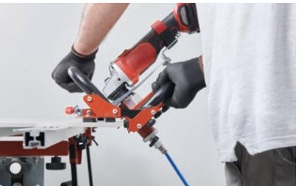
È possibile anche il taglio tramite disco diamantato a secco oppure ad acqua sia a 90° che a 45°.
