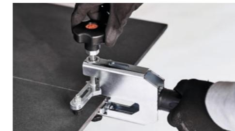
Usare apposite pinze troncatrici per ottenere il taglio ottimale evitando la rottura del materiale.
