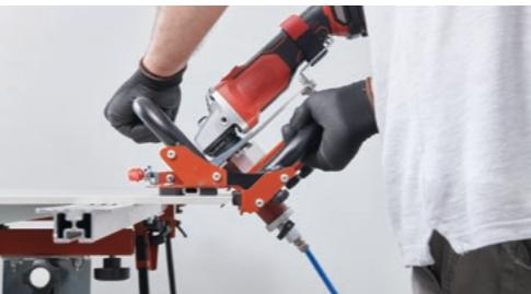
È possibile anche il taglio tramite disco diamantato a secco oppure ad acqua sia a 90° che a 45°.
